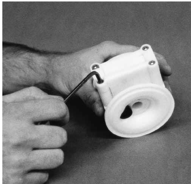
第1步 图1 使用5/32英寸六角扳手(阿伦扳手)将空气阀螺钉从中心体上拆除。(如图1所示)。
