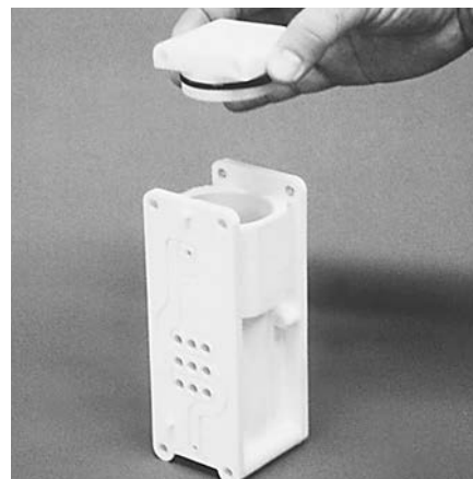
步骤 4 图4 拆除气阀螺栓之后，提起端帽，拆除气阀端帽，露出气阀阀芯。
