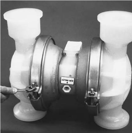
步骤 9 图9 拆除将液室固定在中心体上的大卡箍带。
