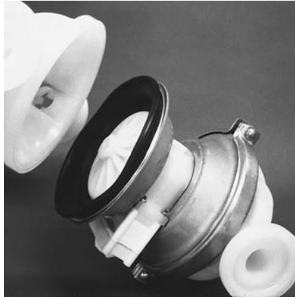
步骤 10 图10 将液室从中心体上提起，以便露出隔膜和外压板。
