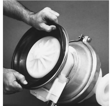
步骤 11 图11 使用可调整扳手或者手动旋转隔膜，拆除隔膜总成。
